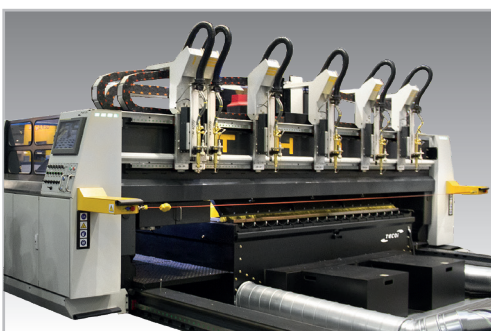
Rear area of the machine for multiple uses: oxy cutting, welding, blasting, etc. Zona posterior de máquina para usos múltiples: oxiacorte, soldadura, granallado, etc.
